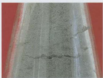
Obr. 2 Trhliny v malte v zužujúcej sa časti fľaše
